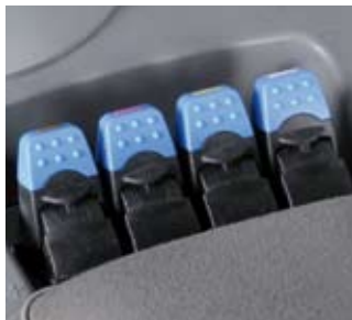
Comando distributori idraulici
